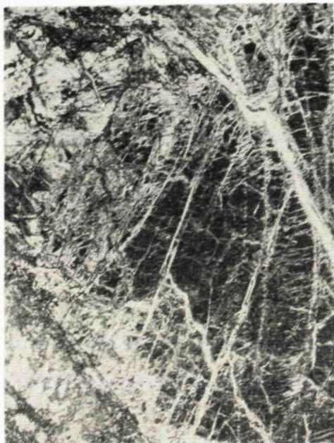
Obr. 6. Steatitizácia porfyrického romboického pyroxénu po puklinách. Zväčš. 11\times , X nikoly.
